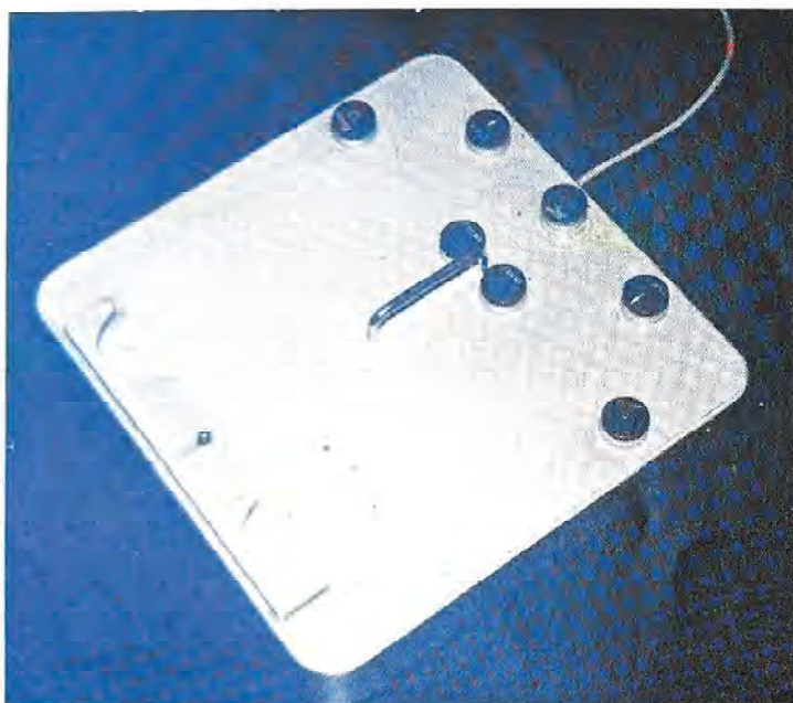
Figura 1 - Pedal de microscópio, exemplificando a disposição dos controles das funções de foco e magnificação colocadas separadamente sem o sistema de movimento em XY.
