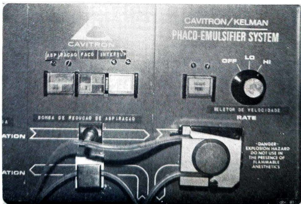
Fig. 9 — Painel de controle, para ajustes de aspiração
