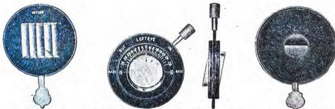
Fig. 1-A — Da esquerda para a direita: baqueta múltipla de Maddox; prisma rotativo de Maddox e duplo prisma do mesmo autor. Apud John Weiss Son, Ltd. Ophthalmic Instruments and Appliances, Londres, 1934.
